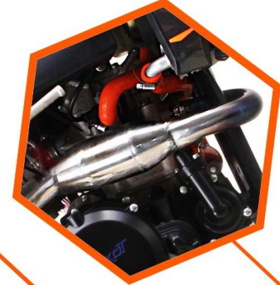
Выхлопная труба из нержавеющей стали с резонатором PowerBomb
